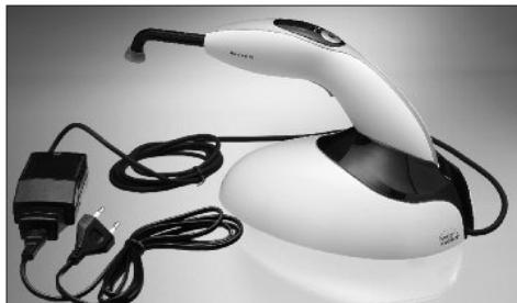
Sluit het netsnoer aan op de netspanning en verbind het andere uiteinde met de netvoedingseenheid.
